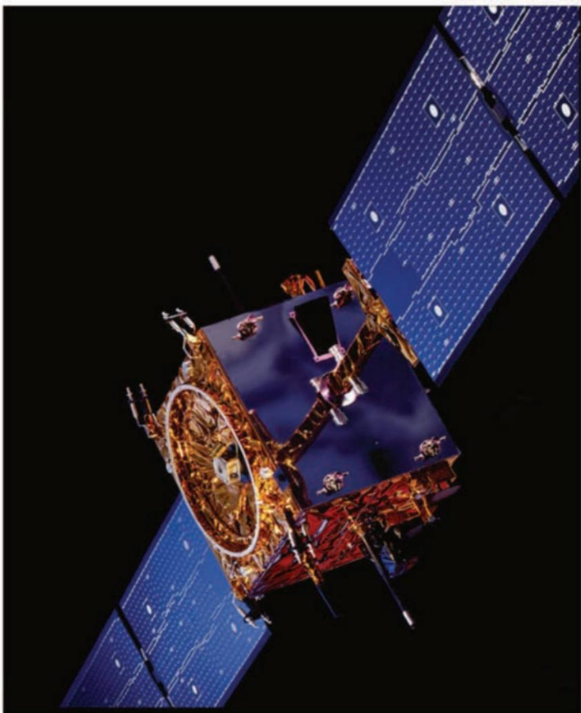
شکل ۳.۱۲ ماهواره‌ی اروپایی اسمارت-۱ با یک موتور محرک یونی (آژانس فضایی اروپا)
