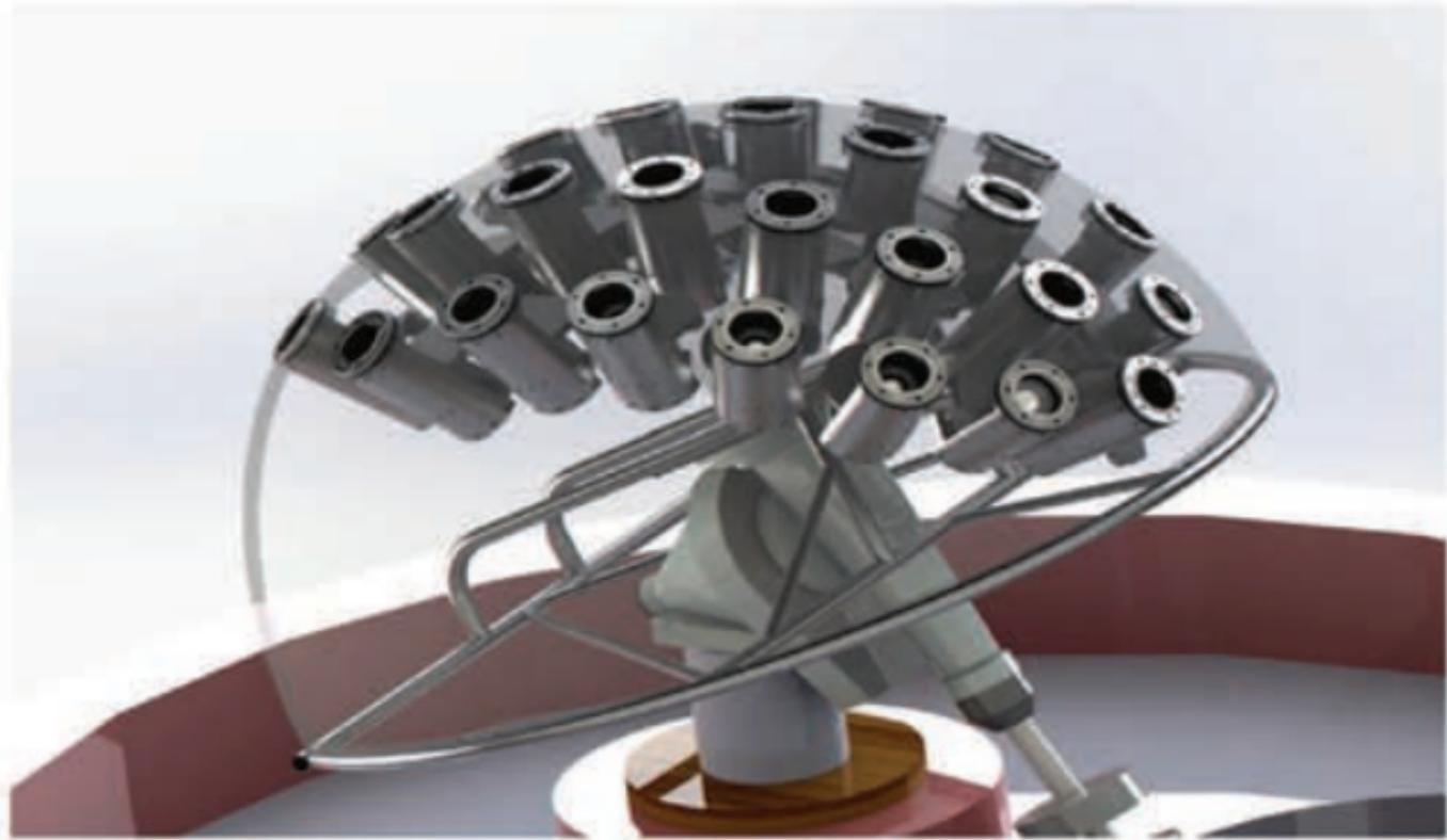
شکل ۷.۷ اوریسکوپ خلاقانه که از ۲۷ تلسکوپ کوچک تشکیل و روی یک پایه سوار شده است
