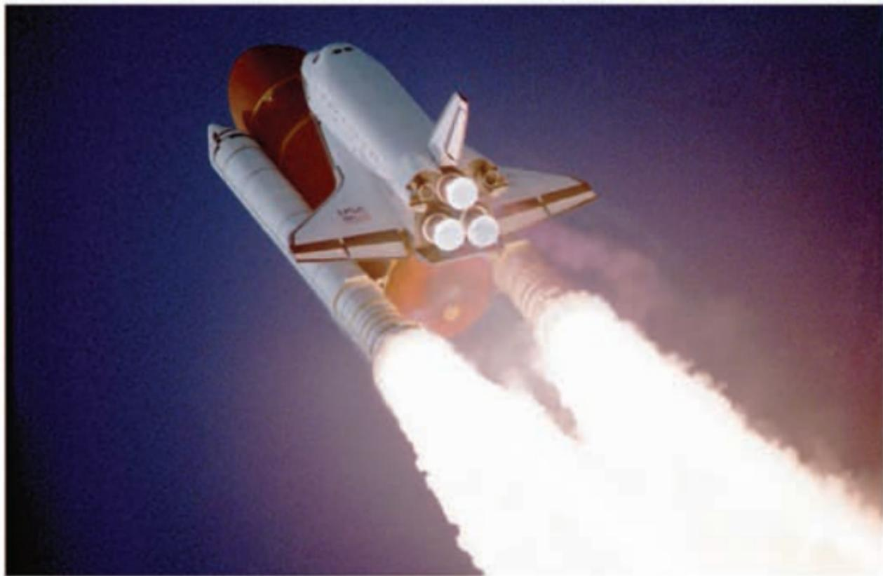
شکل ۲.۱۲ بلند شدن شاتل فضایی آتلانتیس. دو موشک کمکی حاوی سوخت جامد بوده، در حالی که مخزن میانی حاوی سوخت مایع برای موتورهای اصلی شاتل است (ناسا)
